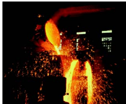
监测熔融金属在浇铸前和浇铸中的温度，以确保正确的冶炼性能
