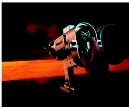
控制热处理部件的温度，确保合理利用能量及时间
