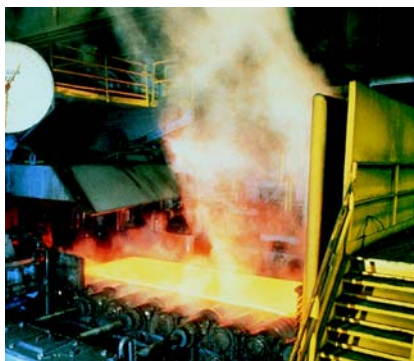
准确测量扁坯、板坯或方坯热轧时的温度，确保产品的一致性
